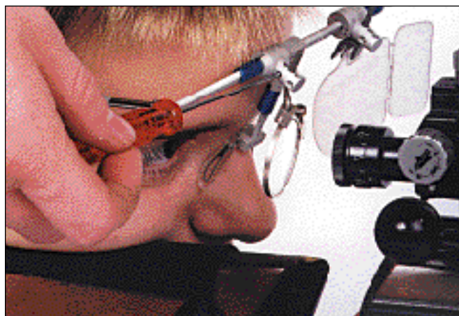
Få en til at hjælpe til med at kontrollere stillingen på glasset, og få det rettet ind efter den skydestilling man skyder mest i.
